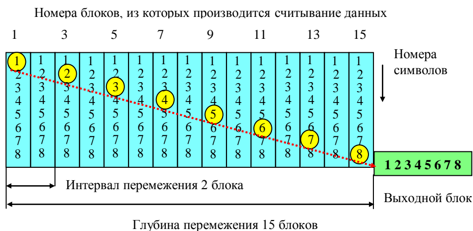
Рис.7.5. Сверточное межблоковое перемежение символов
