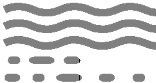
Рис.8.10. Волнообразные канавки и служебные питы на поверхности
