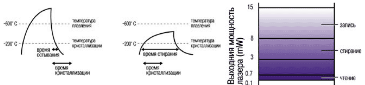
Рис.8.13. Запись, стирание и считывание информации с CD-RW и DVD-RW дисков
