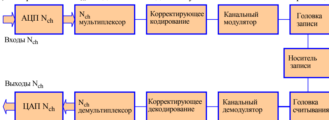
Рис.2.1. Обобщенная функциональная схема записи-воспроизведения звука с АЦП и ЦАП на основе ИКМ
